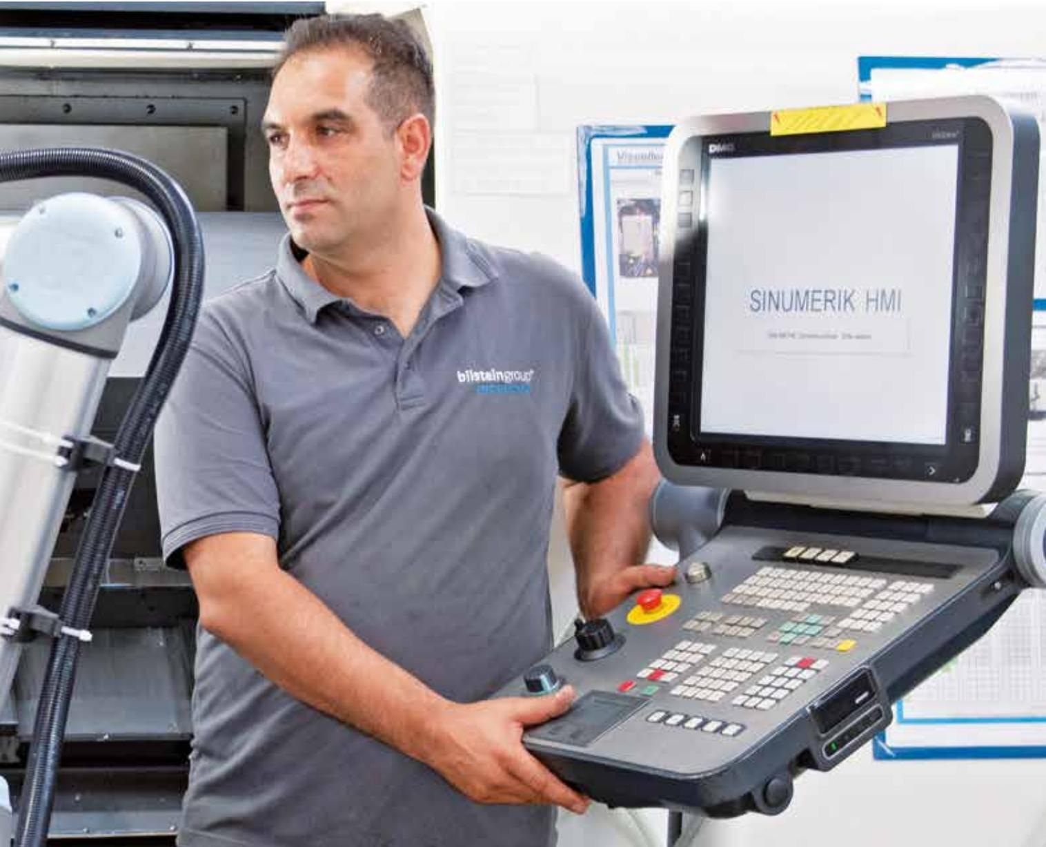
**K**adim Anlamaz kommt gut klar mit seinem „Kollegen“. Er selbst sorgt für den Materialnachschub, prüft die Qualität, schaut nach dem Rechten – während „UR 10“ das Einlegen und Herausnehmen der Teile in die Futterdrehmaschine übernimmt. Präzise und unermüdlich.
