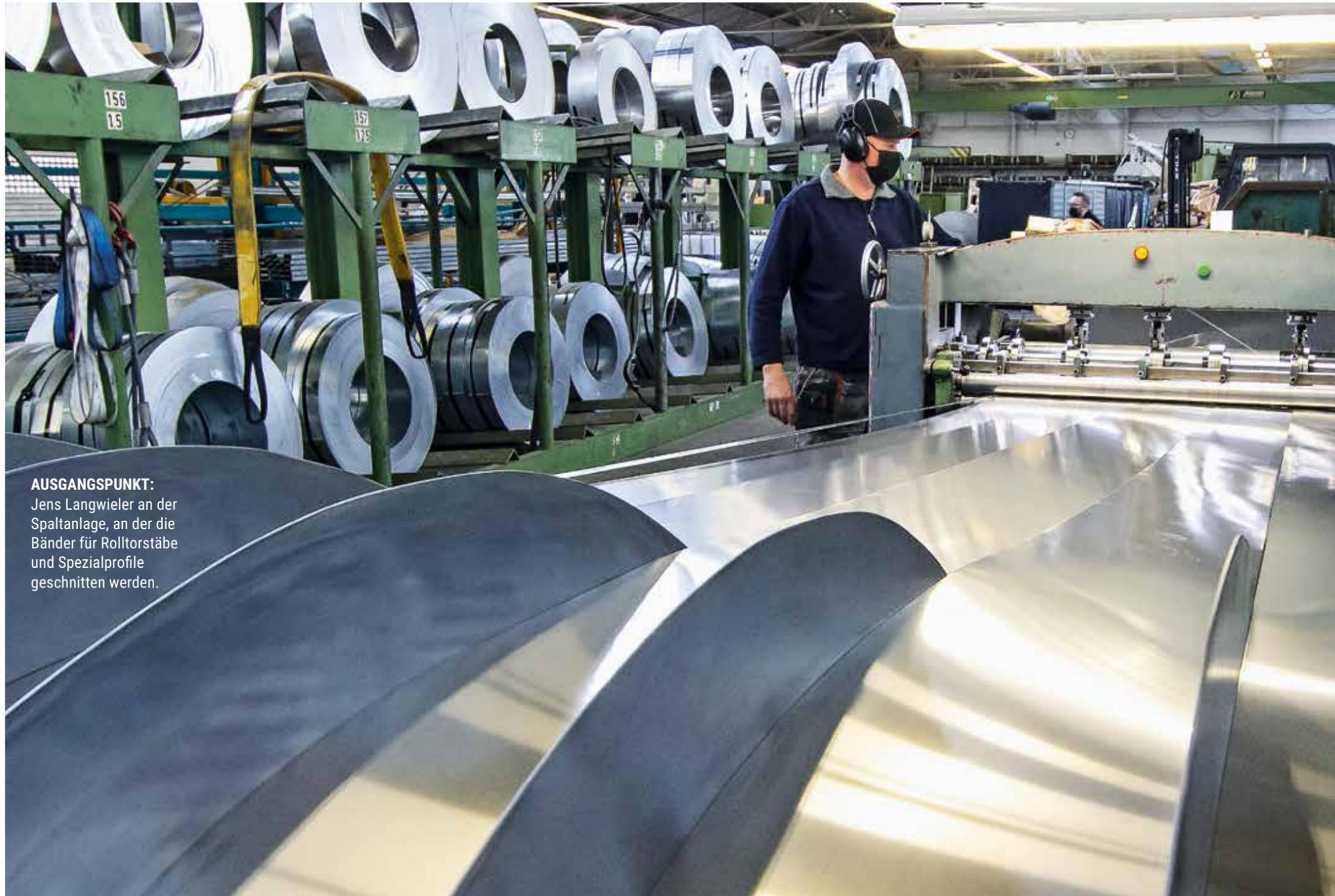
**AUSGANGSPUNKT:** Jens Langwieler an der Spaltanlage, an der die Bänder für Rolltorstäbe und Spezialprofile geschnitten werden.
