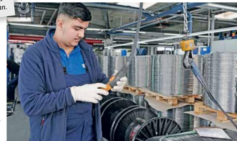
**KEIN STILLSTAND:** Während die Maschine läuft, bereitet Ali Metin eine neue Spule für die Verarbeitung vor.
