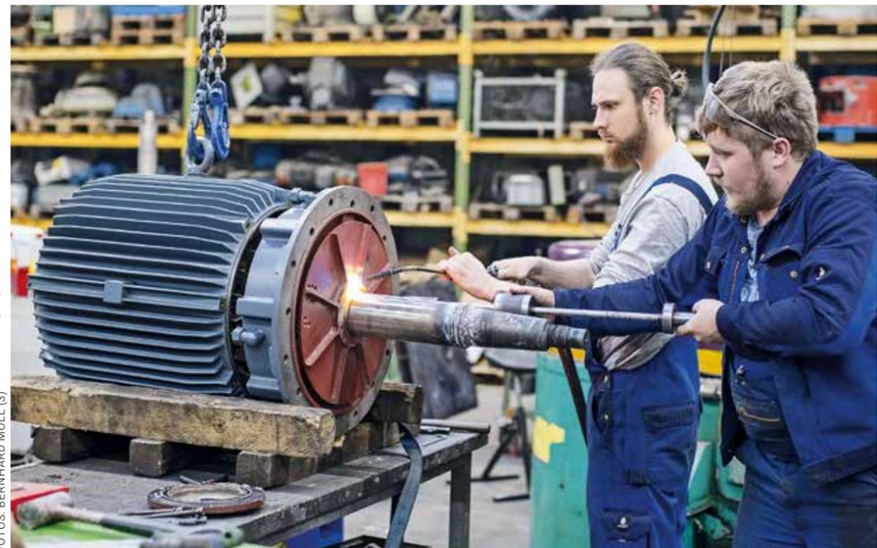
**TEAMWORK:** Marco Rebilas (vorn) und Max Sokolov demontieren den Lager Schild eines Elektromotors.
