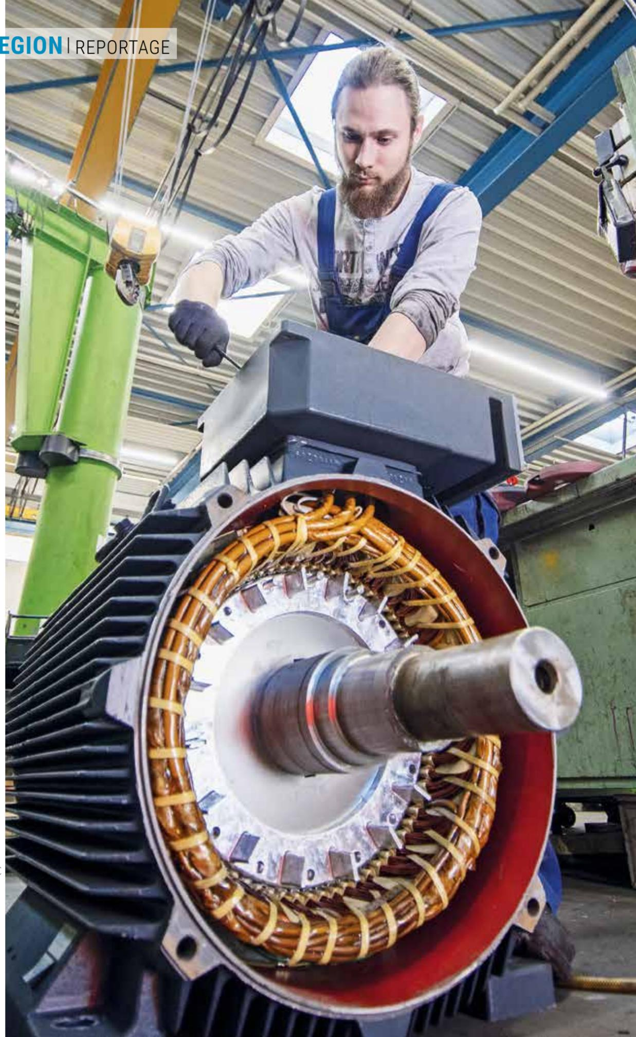
**FAST WIE NEU:** Max Sokolov bei der Instandsetzung eines Elektromotors.
