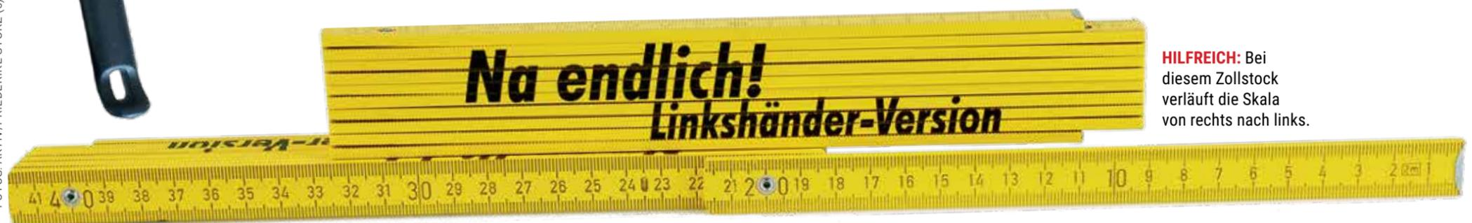
**HILFREICH:** Bei diesem Zollstock verläuft die Skala von rechts nach links.
