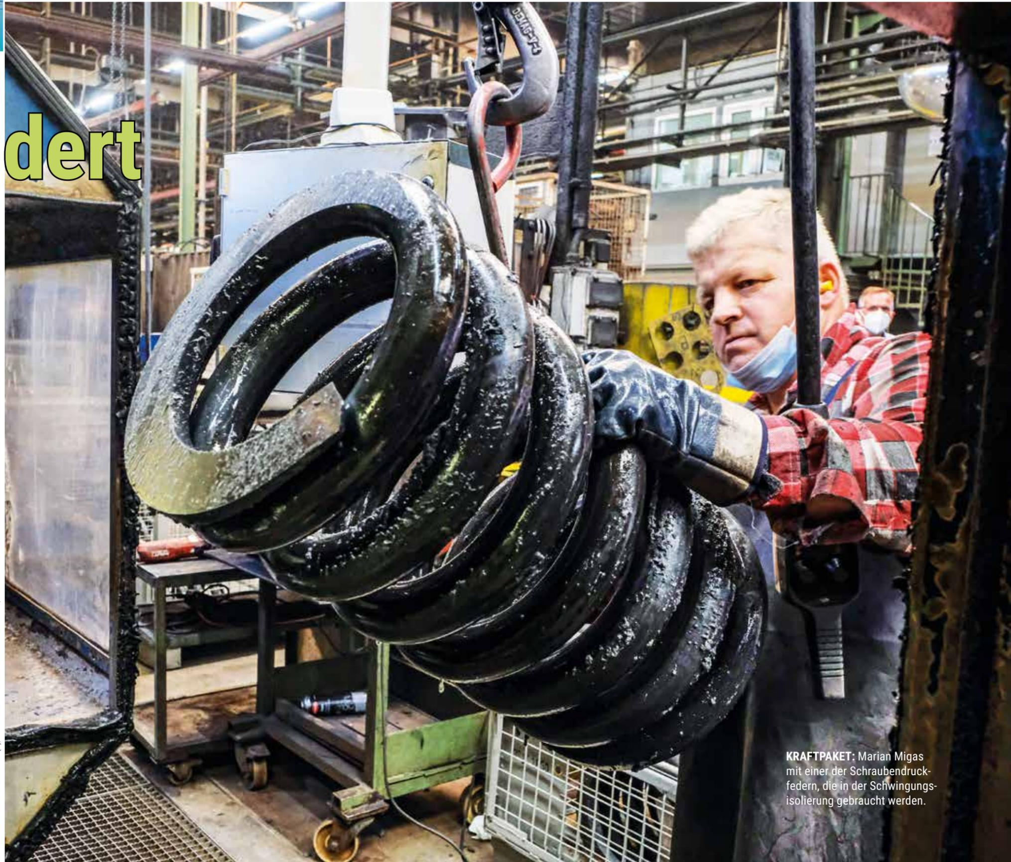
**KRAFTPAKET:** Marian Migas mit einer der Schraubendruckfedern, die in der Schwingungsisolierung gebraucht werden.
