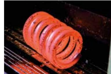
**900 GRAD:** Rot glühend kommen die Federn aus der Wickelmaschine.
