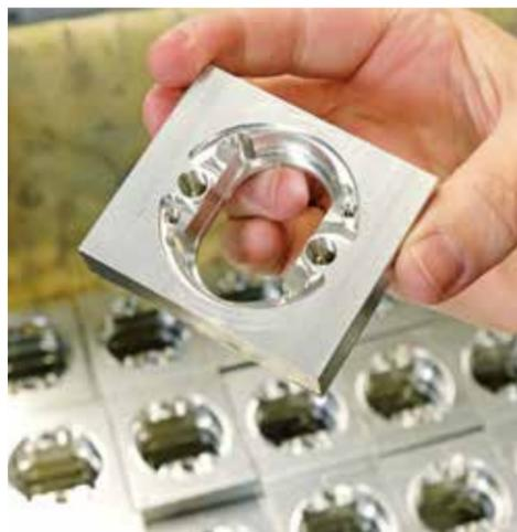
**AUFS GENAUESTE GEFRÄST:** Die Rückseite einer Schutzrosette.
