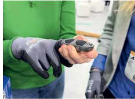
**FÜR STECK-ARBEITEN:** Das Exoskelett für die Finger stammt aus dem 3-D-Drucker.
