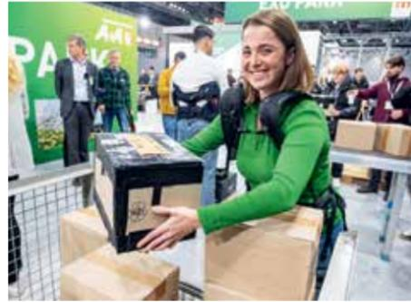
**SCHWERE LASTEN HEBEN:** Das Gewicht wird über Becken und Oberschenkel abgeleitet.
